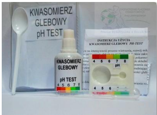
Pehametr polowy Helliga do oznaczeń pH gleby w warunkach terenowych
