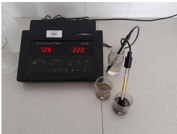
pehametr z elektrodą szklaną oraz czujnikiem temperatury
