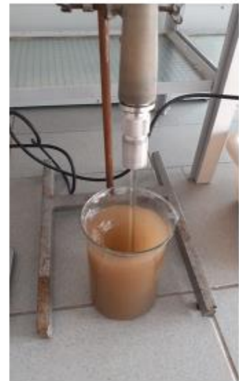
dyspergowanie zawiesiny glebowej z pomocą mieszadła
