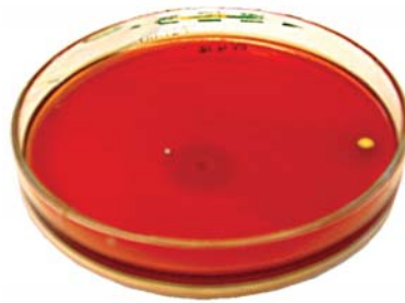
Rys.2 Płytkę Petriego używaną do badania czystości mikrobiologicznej powietrza oraz widok kolonii mikroorganizmów wyhodowanych na płytce Petriego, pochodzących z powietrza wentylacyjnego [5, 6]
